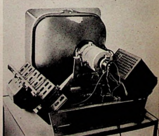
Bild 4. Chassis-Aufbau des Metz 901
